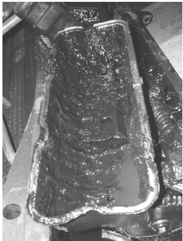
Abbildung 6: Ablagerungen von eingedicktem Motoröl an der Kurbelwelle und in der Ölwanne (links) sowie am Ventildeckel (rechts)
