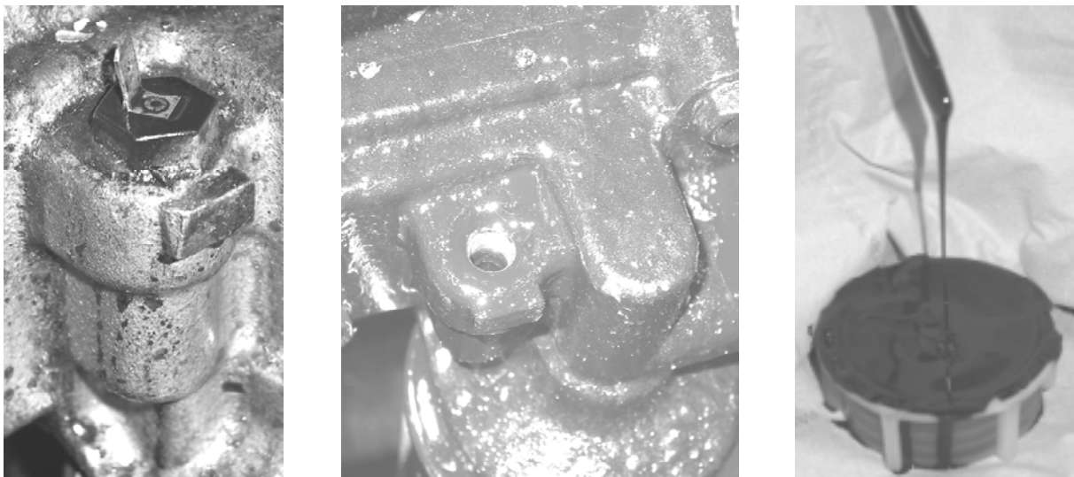
Abbildung 5: Motoröl-Verschmutzungssensor (links), fehlender Sensor (Mitte) und hochviskoses Motoröl (rechts)
