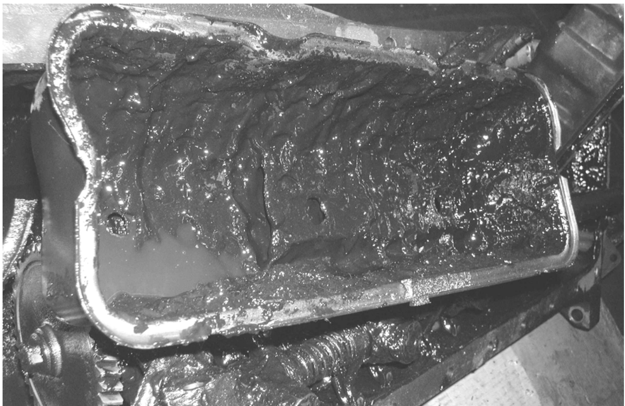
Abbildung 1: Eingedicktes Motoröl am Ventildeckel eines mit Rapsöl betriebenen Traktors (Foto: Miller)
